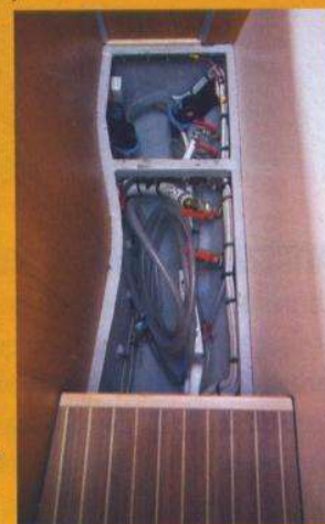
A destra, una delle sentine, con le prese a mare e le pompe, di facile ispezione
